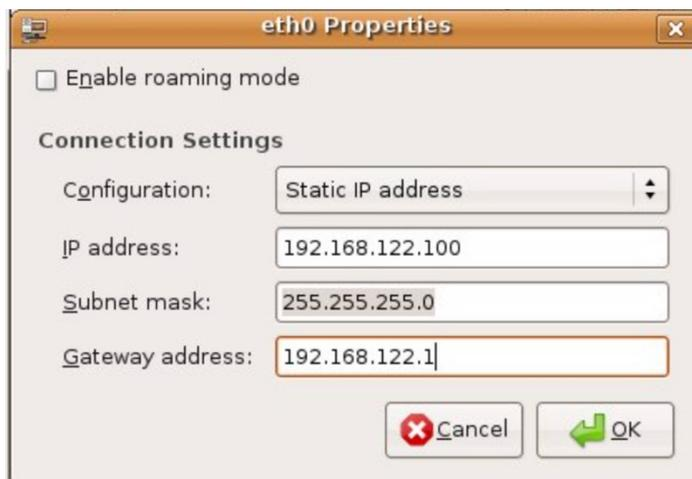
Adresse IP d'un ordinateur connecté à un réseau local (et possédant une adresse masque de sous-réseau) et utilisant une passerelle possédant elle-même une adresse IP
